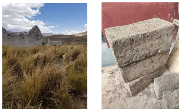
Figura 3: Fibra vegetal denominada ichu (izquierda) y bloques de adobe con ichu tras el secado (derecha).
