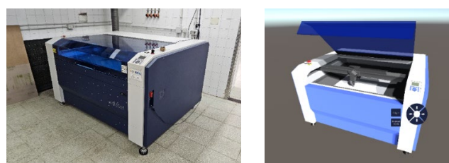
Fig 1. Imagen de la máquina real y del gemelo digital.
